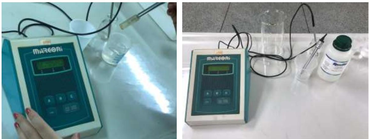
**Figura 25.** Condutivímetro e solução padrão para determinação da condutividade elétrica da água com sementes de amendoim. Dourados, 2017
